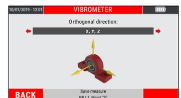
Schritt 3: Wählen der Messrichtung X,Y oder Z
